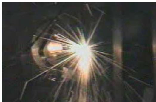
Fig. 3. The solid aerosol fly apart, P_m = 0,3 Torr
